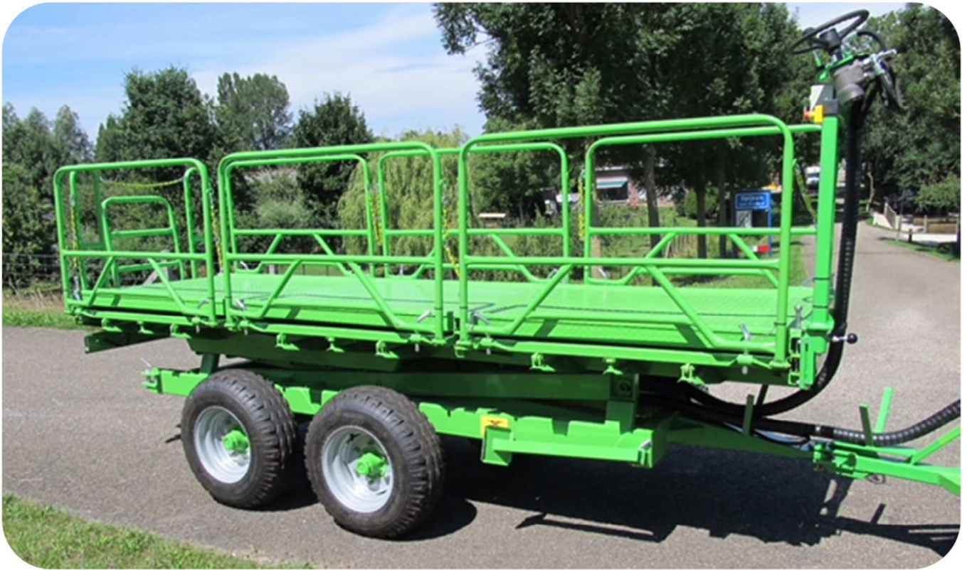
Platforma hoogwerker tandem-as: voor het snoeien, netten plaatsen, voor de oogst, platform lengte 4.30m, breedte 1.45m (uitgeschoven 3.15m), hoogte platform 3.25m
