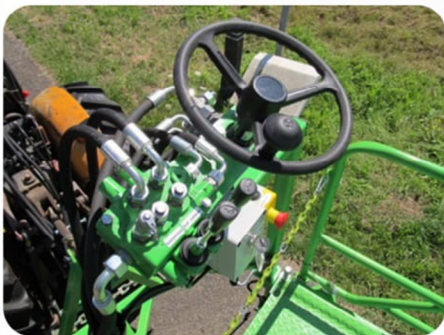
Platforma hoogwerker tandem-as: voor het snoeien, netten plaatsen, voor de oogst, platform lengte 4.30m, breedte 1.45m (uitgeschoven 3.15m), hoogte platform 3.25m
